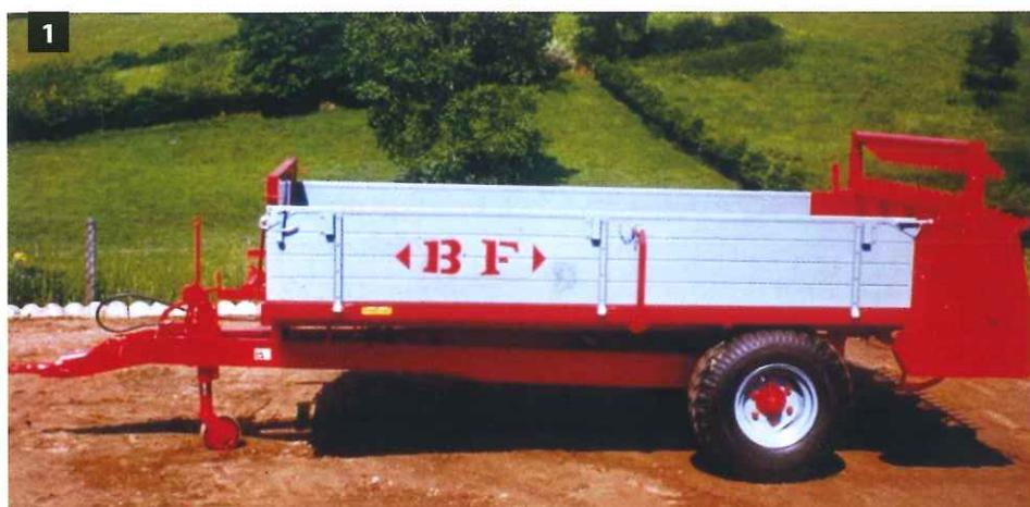
**Fig. 1 :** La remorque basculante multifonction équipée en épandeur.
