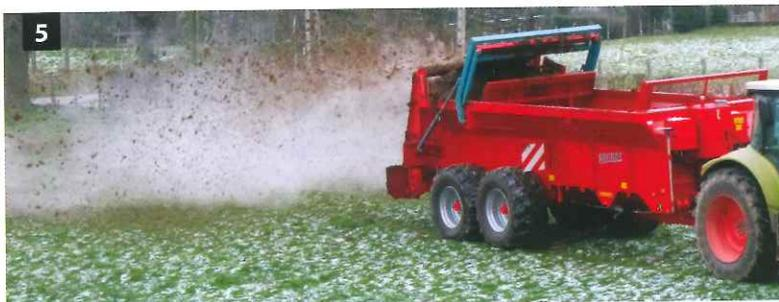
Fig. 5 : Épandeur à double essieux.
