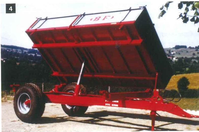
Fig. 4 : Remorque basculante tri-benne.
