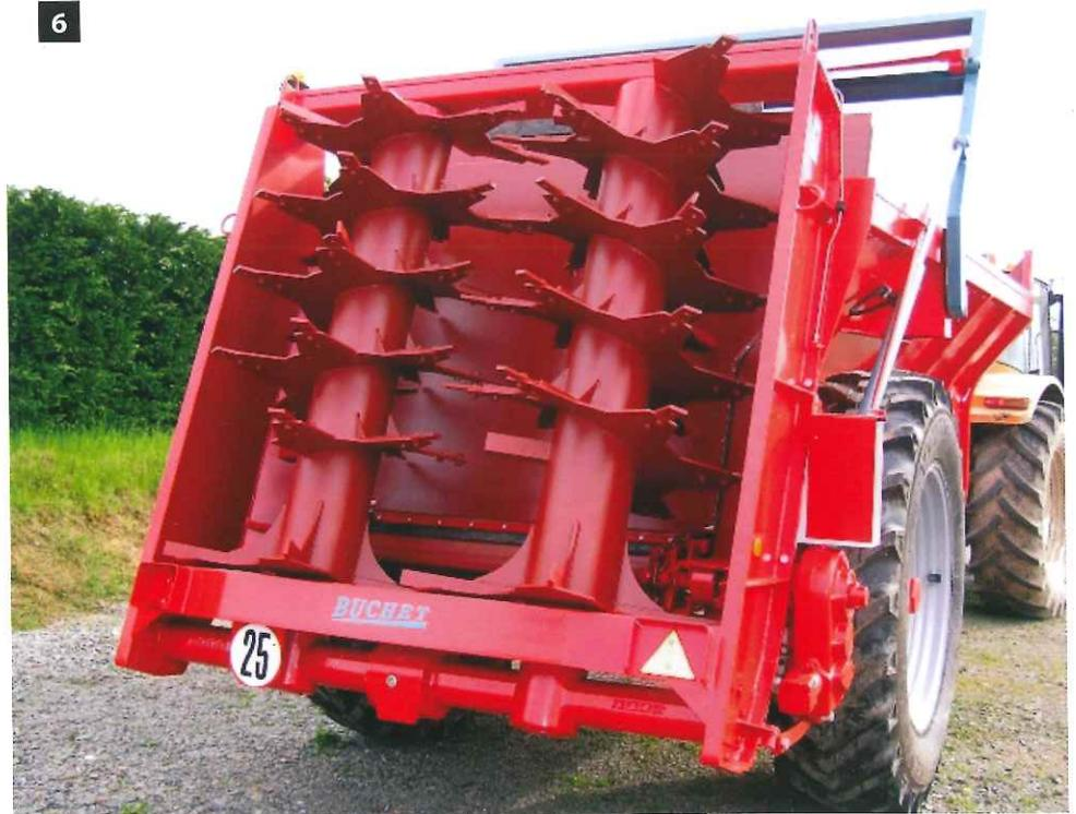
Fig. 6 : Épandeur à deux hérissons verticaux.
