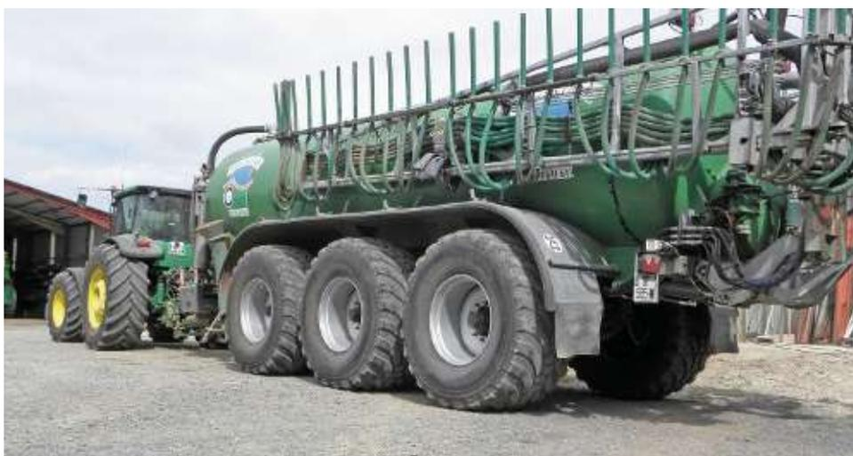
L'adoption de pneus VF sur le tracteur et le véhicule remorqué constitue un ensemble cohérent, capable d'évoluer au champ à des pressions de gonflage bien inférieures à celles des carcasses classiques diagonales ou radiales.
