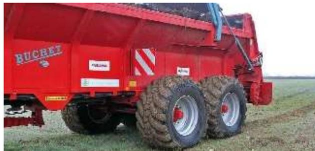
**Le surcoût des pneus VF** de l'épandeur à fumier est compensé par les effets positifs en termes de respect du sol et de réduction de la puissance de traction.
