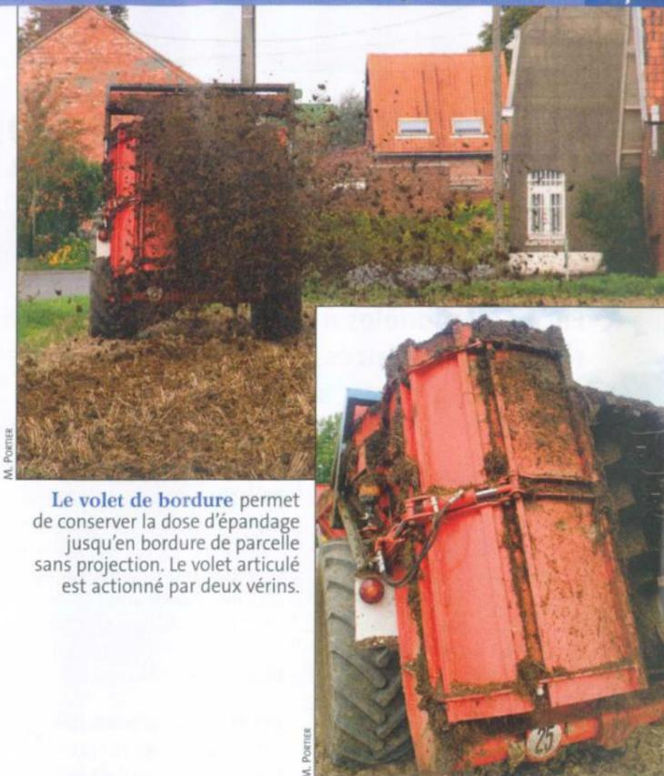
Le volet de bordure permet de conserver la dose d'épandage jusqu'en bordure de parcelle sans projection. Le volet articulé est actionné par deux vérins.
