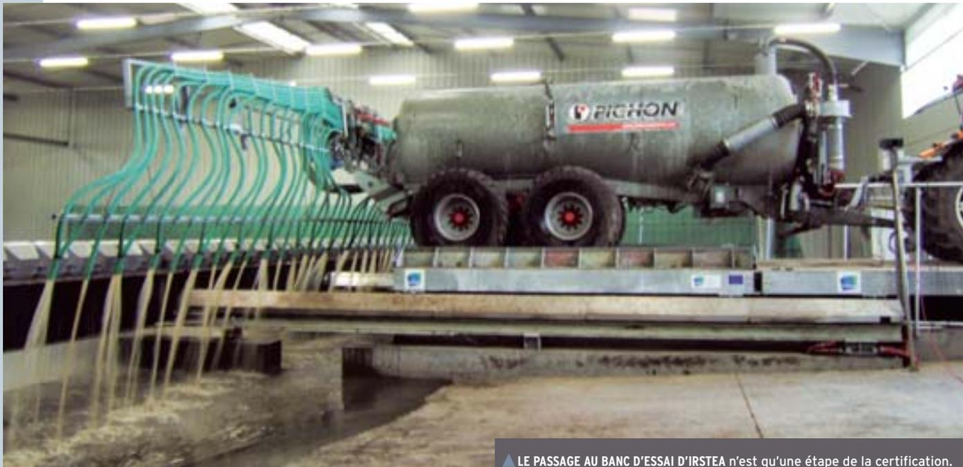
▲ LE PASSAGE AU BANC D'ESSAI D'IRSTEA n'est qu'une étape de la certification. Un audit du constructeur est réalisé en parallèle.
