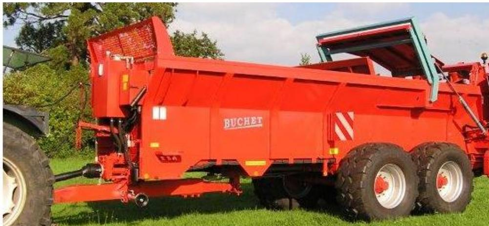
L'épandeur Buchet EHV 20/13, d'une charge utile de 13 tonnes, adopte sur son essieu tandem un dispositif inédit capable de délester au choix les roues avant ou celles arrière.
