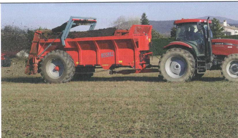
L'épandeur de 13m<sup>3</sup> de la cuma de Redan est équipé d'un DPA et d'un système de pesée intégré. Acheté en 2011, il épand 4 000 t/an de fumier.
